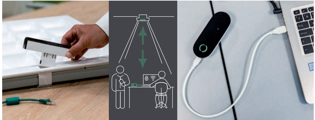
Po lewej: oprawa oświetleniowa z nadajniko-odbiornikiem. Pośrodku: zasada działania. Po prawej: klucz dostępu USB.
