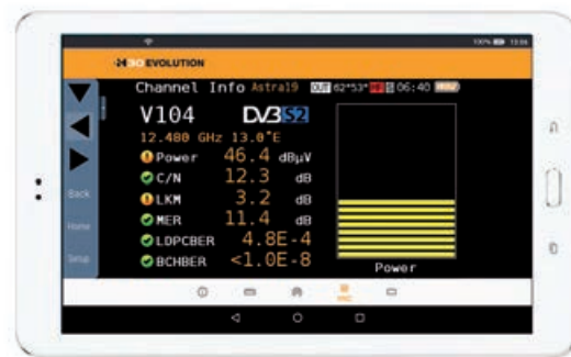
Miernik natężenia pola H30E-F może łączyć się ze smartfonami i tabletami.
